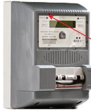
Punto per il montaggio per la testina di relavazione su contatori elettronici tipo LANDIS & GYR
