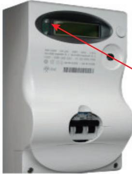
Punto per il montaggio per la testina di relavazione su contatori elettronici tipo GEM / GET
